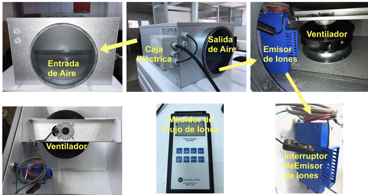
Figura 2. Imágenes de equipo de aire forzado con emisor de iones incorporado y detector de flujo de iones portátil.
